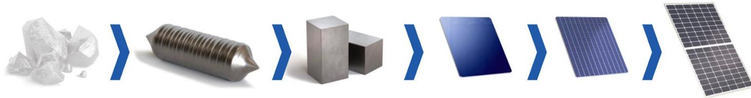
Produire et commercialiser des **wafers**, **cellules** et **modules** compétitifs, fiables, durables, **haut rendement** et **très bas carbone**
